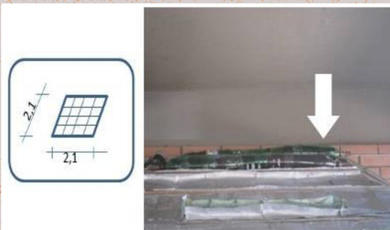
Figura 4 Painel construído com garrafas pet, caixas tetrapak, restos de canos de PVC
