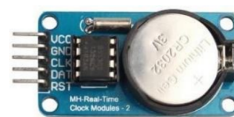
Figura 3 – Circuito Impresso Shield RTC DS 1302
