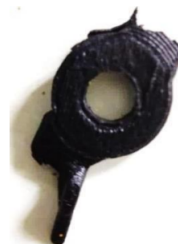
Figura 10 – Válvula Meia-Lua após rompimento
