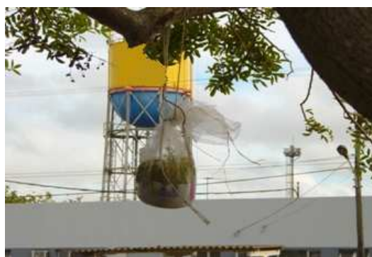
Figura 2 - Método “moss bag” utilizado no estudo, o qual consiste na suspensão de sacos de nylon, contendo 30g de Sphagnum , sobre galhos de árvores a aproximadamente três metros do solo.
